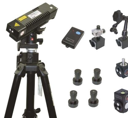
\*PSD = position sensitive device. Ein System, das einen von einer Laserquelle erzeugten Laserstrahl als Referenz für eine Vermessung nutzt. Entlang des Laserstrahlers wird mit dem PSD der Abstand zum Messobjekt erfasst. Näheres hierzu finden Sie z.B. unter [www.statuspro.de/maschinengeometrie/geradheitsmessung](http://www.statuspro.de/maschinengeometrie/geradheitsmessung)
